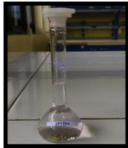
Pembuatan larutan standar 100 ppm
