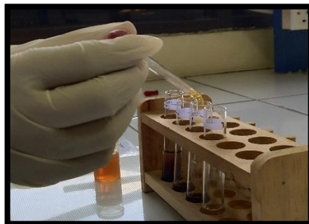
Diteteskan pereaksi \text{FeCl}_3 pada larutan uji sampel (apabila positif akan terjadi perubahan warna menjadi ungu)
