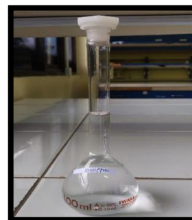
Pembuatan larutan standar 1000 ppm
