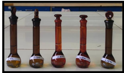
Pembuatan larutan seri konsentrasi 8, 10, 12, 14, dan 16
