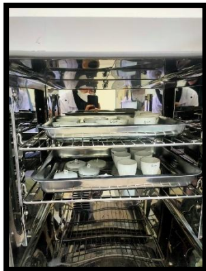
Proses Pemanasan Krush pada oven selama 30 menit dengan suhu 60°C
