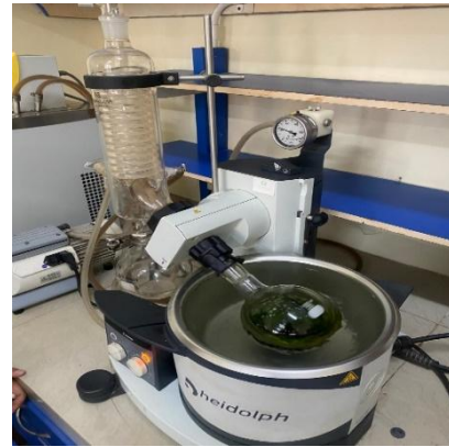
Pemekatan maserat dengan Rotary Evaporator
