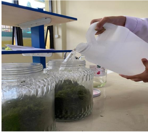
Penuangan etanol 96% pada proses maserasi sampel daun andong
