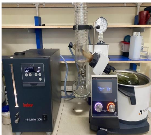
Pengentalan sampel daun andong dengan rotay evaporator
